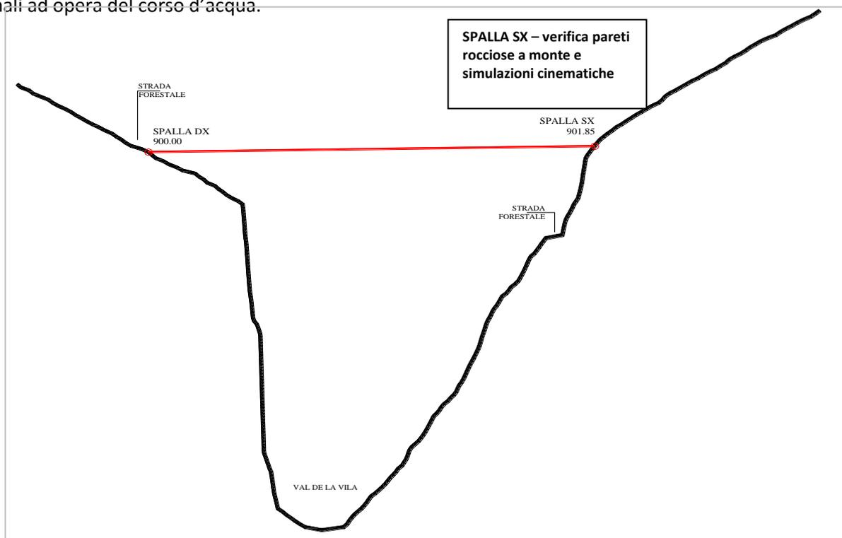
**Fig. 8.7.1 – sezione schematica di Val de la Vila in corrispondenza del ponte tibetano – il ponte risulta sospeso ad un'altezza di circa 130 m rispetto al fondo della valle**
