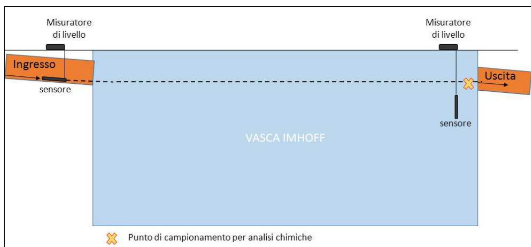
Figura 22. Carbonare - Schema della vasca Imhoff con indicazione del punto in cui si sono effettuati i campionamenti e le sezioni di misura dei livelli per la stima delle portate.
